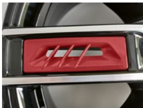
Gleichmäßiger umlaufender Spalt zwischen Rad und Kunststoffteil
