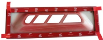
Partie arrière de l'élément de design avec ruban adhésif double-face
